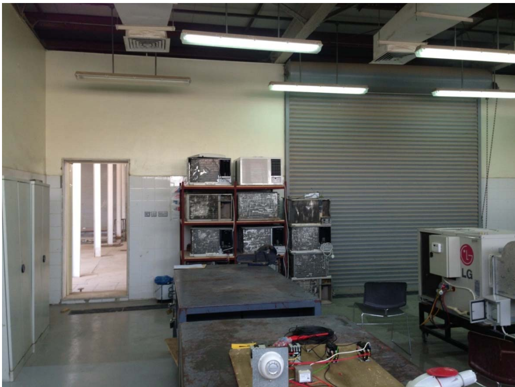
شكل (11): يوضح غياب منافذ التهوية بورشة التبريد والتكييف
